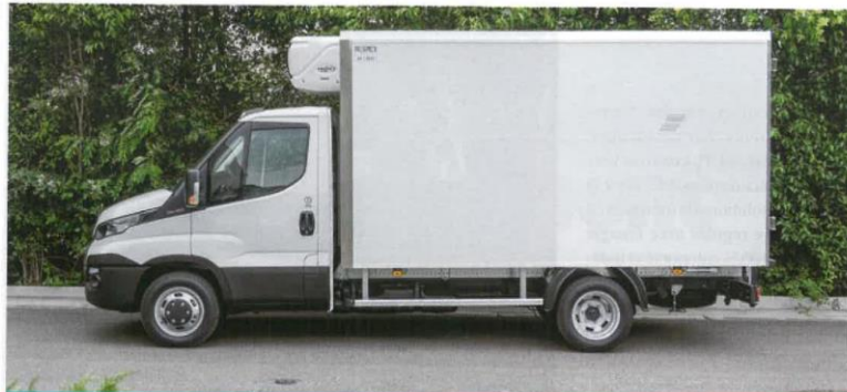
Un Iveco Daily châssis cabine avec une caisse frigorifique Iso Van Isberg by Gruau.
