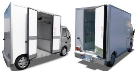
LAMBERET propose deux versions de caisse sur le COLIBUS : avec portes latérales (à gauche) ou porte arrière (à droite).
